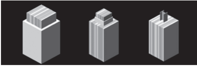
木質耐火部材（左から、一般被覆型、燃えしろ被覆型、鉄骨内蔵型）
